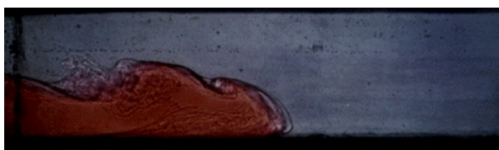
Figuur 2. Voortplanting van de (rode) zouttong vanaf zee naar rechts over een bodem. Niet zichtbaar is de retourstroming van lichter rivierwater naar links boven de zouttong (Friocourt e.a. 2012).
