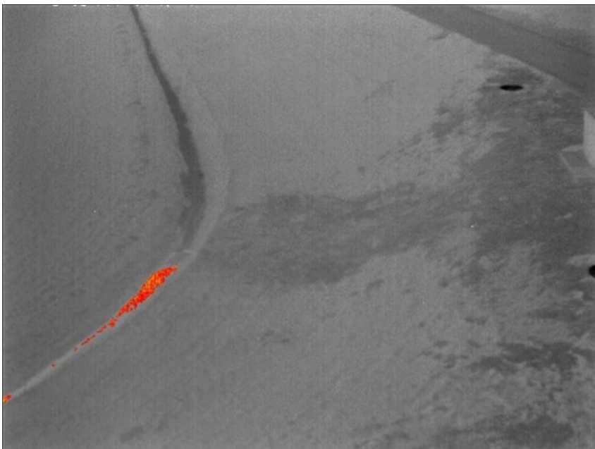
Uittredend water in een teensloot bij een dijk, gemeten met infrarood
